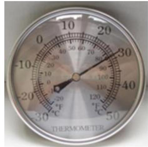
**Gambar 4.4** Termometer bimetal, digunakan untuk pengukur suhu
